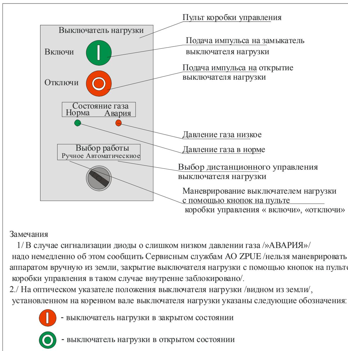
Рис.7 Размещение кнопок на пульте управления выключателя нагрузки
